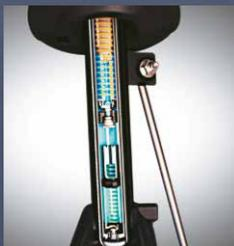
En las compresiones y extensiones importantes, los topes hidráulicos controlan el movimiento de forma progresiva, reduciendo la agresividad y evitando las paradas bruscas de la suspensión, así como los fenómenos de rebote generalmente asociados con la sensación de mareo.
